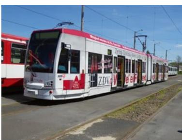
BILD 2: Moderne Niederflurstraßenbahnen erreichten Bremsungen aus 30 km/h eine maximale Verzögerung von 4,9 m/s<sup>2</sup>
